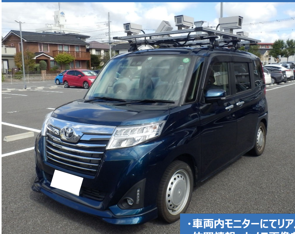
前後ステレオカメラ・側方カメラ・GPS 計6台のカメラを搭載
