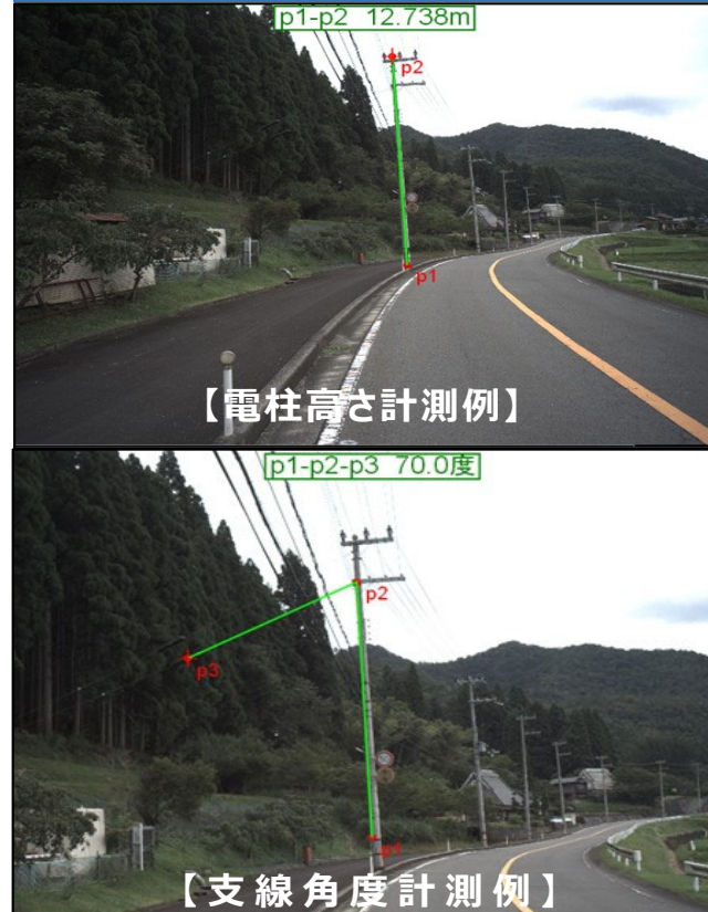
ステレオカメラ画像から高さ・角度を計測
